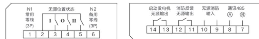
□ 三极产品的工作零线输入: 1 端口为常用零线, 6 端口为备用零线。
